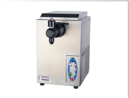
Sahne Automat EURO-CREAM-STAR Edelstahl rostfrei 18/10 Sahnefreies Magnetventil (patentrechtlich geschützt), Hand- Portionierung mit 3 Portionstasten (individuell einstellbar), Intensivkühlung bis in die Garniertülle, Desinfektionsreinigung im Durchspülverfahren, robuste Geräteschalter, An-/Ausschalter für Gerät/ Kühlung, mit Reinigungsautomatik verarbeitet bis zu 95 l Sahne pro Stunde 230V~1 / 50-60 Hz 22.8x34.6 cm h 45.9 cm, 28 kg, 2 l Inhalt • Art. 120539
