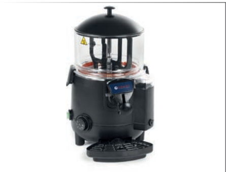
Schokogerät Edelstahl/PC Boden des Behälters aus Edelstahl, Seiten aus PC Aptropfbehälter mit Schwimmer und Überlaufwarner Überhitzungsschutz homogene Konsistenz der Schokolade durch ständiges Rühren - spezieller Ablasshahn Temperaturbereich: +65°C bis +85°C benötigte Umgebungstemperatur: +10°C bis 32°C 1006 W - 230 V 41x28 cm h 46.5 cm, 5 l • Art. 113094
