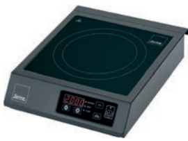
Induktionsplatte Edelstahl rostfrei 18/10, schwarz auch zum Warmhalten, stabiles Design Gehäuse aus Edelstahl/gehärtetes Glas Temperatureinstellung von 60°C - 240°C 10 Leistungsstufen von 500-3500 Watt Timer bis zu 3 Stunden Großes LED-Display Rutschfeste Füße 220-240 V - 50/60 Hz 500-3500 Watt 32x40 cm h 9.5 cm Art. 126739
