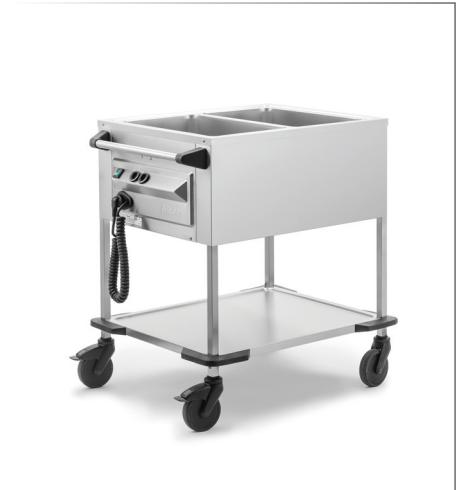
Zubringerwagen ZUB2 RIEBER Edelstahl rostfrei 18/10 naß und trocken beheizbar Fassungsvermögen 2 x GN1/1 200 mm Abdeckung allseitig verkröpft, tiefgezogene Warmhaltebecken eingeschweißt isoliert, spritzwassergeschützt Sicherheitsschiebegriff, Griffstellung stirnseitig Eingeschweißtes Edelstahl-Bord, 4 Stoßbecken Bei trockener Beheizung deutliche Energiesparnis Mit Entleerhahn Schaltelemente stoßgeschützt Spiralkabel 2.5 m, Blindsteckdose , Ein-/Aus-Wippschalter Thermostatregler stufenlos, +30 °C bis +110 °C Rostfreie Rollenausstattung ø 125 mm, 2 Lenkrollen Nennspannung 1N AC 230V, 50 Hz, Anschlußwert 0.94 kW 85.8x67.5 cm h 90 cm, Leergewicht 33 kg • Art. 119316
