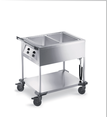
Speisenausgabewagen SAW2 B.PRO Edelstahl rostfrei 18/10, naß und trocken beheizbar 2 Warmhaltebecken - fugenlos eingeschweißt, tiefgezogen, offenes Untergestell mit abgekantetem Ablagebord, eingeschweißt Becken separat regel- und beheizbar für 2 x GN 1/1-200 mm Stufenlose Temp.einstellung je Becken: +30°C bis +95°C Sicherheitsschiebegriff mit seitlichen Stoßschutz-Elementen geprägte Füllstandsmarkierung (4 Liter) in den Becken Ablasshahn gegen unbeabsichtigtes Öffnen gesichert Spritz- und strahlwassergeschützt, Arbeitshöhe 90 cm Kunststoffrollen ø 125 mm, 2 Lenkrollen, 2 Lenkstopprollen Bedienfeld mit Ein-/Aus-Schalter, Kontrollleuchte, Spiralkabel, Blindsteckerbuchse und Temperaturregler an Stirnseite Nennspannung 220-240 V, 50-60 Hz, Anschlußwert 1.4 kW 93.6x71.4 cm h 93.3 cm, Leergewicht 35.5 kg • Art. 119356
