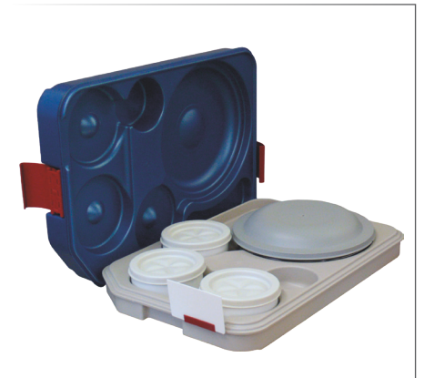
Speisentransportbehälter BLU TRAY isoliertes, passives Speisentransporttablett zum Warm- oder Kalthalten Polypropylen, ausgeschäumt mit Polyurethan Deckel blau metallic, Unterteil grau passiv beheizt durch Heizeinlett mit Aluminiumkern Warm- und Kaltbereiche sind thermisch getrennt Temperatureinsatzbereich: -20°C bis + 100°C jedes Porzellanteil ist separat und dicht abgedeckt spülmaschinentauglich mit 2 Bügelverschlüssen kurzfristige thermische Desinfektion bis +130°C möglich 37x53 cm h 11.4 cm • Art. 127476 bestückt mit 1 Hauptspeiseteller, 3-geteilt 1 Suppentasse 2 Kaltschalen 4 Abdeckungen
