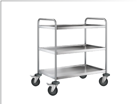
Servierwagen 8x5x3 B.PRO 3 Ablagen Edelstahl rostfrei 18/10 lichtes Maß zwischen den Borden: 27.5 cm Maße der Borde: 80x50 cm Tragfähigkeit je Ablage: max. 80 kg Tragfähigkeit je Wagen: 120 kg Maße: 90x60 cm h 95 cm Gewicht (Kunststoffrollen): 18 kg Rollen ø 125 mm, 4 Lenkrollen, davon 2 mit Feststeller • Art. 125991 Rollen aus Kunststoff • Art. 119717 Rollen stahlverzinkt
