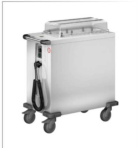
Universalspender UNI-H 59/29 B.PRO Plattform 59x29cm Edelstahl rostfrei 18/10 Umluft-beheizt mit 1 Stülpedeckel geschlossene Ausführung mit 6 Führungsstäben Stoßschutzecken an allen Ecken stabiler CNS-Schiebegriff mit integriertem Stoßschutz spritz- und strahlwassergeschützt Temperatur regelbar von +30°C bis +110°C mit Kunststoffrollen Rollen ø 125 mm, 4 Lenkrollen, davon 2 mit Feststeller Gewicht: 68,5 kg Leistung: 1.8 kW 220-240 V, 50-60 Hz 88.5x52 cm h 94,4 cm • Art. 119360
