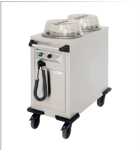
Röhrenstapler RRV-H2 RIEBER Edelstahl rostfrei 18/10 - statisch beheizt Korpus doppelwandig, isoliert stoßgeschützte Schaltelemente flexibler Einstellmechanismus für Teller ø 190 - 320 mm Röhrendurchmesser: 397 mm Zuladung pro Röhre max. 75 kg Plattform kipp- und verkantsicher geführt Ausgabehöhe verstellbar über Federn Sicherheitsschiebegriff. 4 Stoßecken Rostfreie Rollenausstattung Rollen ø 125 mm, 2 Lenkrollen, 2 Lenkstopprollen mit Überhitzungsschutz Spiralkabel 2.5 m, Ein-/Aus-Schalter, Blindsteckdose Thermostatregler +30 °C bis +110 °C 1.4 kW; Nennspannung 1N AC 230 V, 50 Hz Einsatzbereich: +30°C bis +90°C 95.5x48 cm h 90 cm, Gewicht 55 kg • Art. 119328
