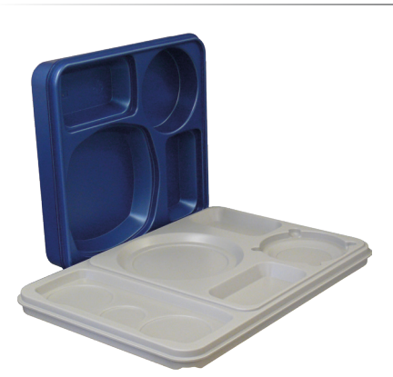
Speisentransportbehälter BLU TRAY ITALY isoliertes, passives Speisentransporttablett zum Warm- oder Kalthalten Polypropylen, ausgeschäumt mit Polyurethan Deckel blau metallic, Unterteil grau leichte, robuste Bauweise bestehend aus Ober- und Unterteil Warm- und Kaltbereiche sind thermisch getrennt Temperatureinsatzbereich: -20°C bis + 100°C spülmaschinentauglich kurzfristige thermische Desinfektion bis +130°C möglich 37x53 cm h 10 cm • Art. 127477 unbestückt
