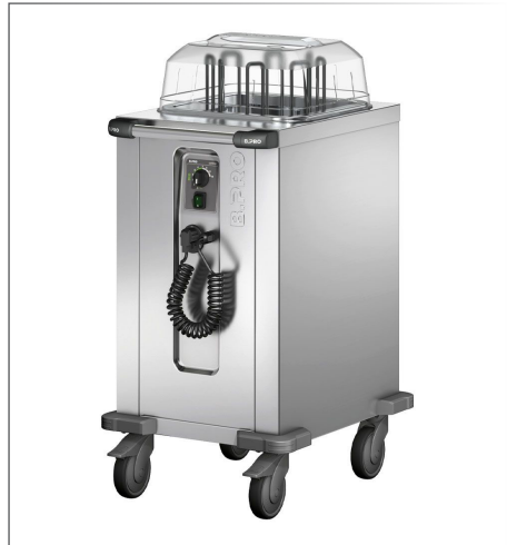
Tellerspender TS-H1 18-33 B.PRO Edelstahl rostfrei 18/10 statisch beheizbar inkl. Abdeckhaube aus PC inkl. Halteclip für Abdeckhauben quadratische Tellerröhren, komplett entnehmbar Easy-Setting-System für einfache Federeinstellung Temperatur regelbar von +30°C bis +110°C Kapazität: ca. 80 Teller, rund ø 18-33 cm, eckig 28 x 28 cm mit Kunststoffrollen, rostfrei Rollen ø 125 mm, 4 Lenkrollen, davon 2 mit Feststeller Gewicht: 44 kg Leistung: 0.9 kW 220-240 V, 50-60 Hz 68x52 cm h 103 cm • Art. 119355
