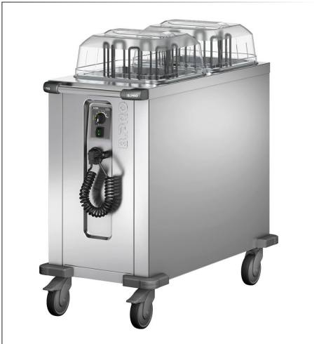
Tellerspender TS-H2 18-33 B.PRO Edelstahl rostfrei 18/10 statisch beheizbar inkl. Abdeckhaube aus PC inkl. Halteclip für Abdeckhauben quadratische Tellerröhren, komplett entnehmbar Easy-Setting-System für einfache Federeinstellung Temperatur regelbar von +30°C bis +110°C Kapazität: ca. 160 Teller, rund ø 18-33 cm, eckig 28 x 28 cm mit Kunststoffrollen, rostfrei Rollen ø 125 mm, 4 Lenkrollen, davon 2 mit Feststeller Gewicht: 69 kg Leistung: 1.20 kW 220-240 V, 50-60 Hz 107.6x52 cm h 103 cm • Art. 116834
