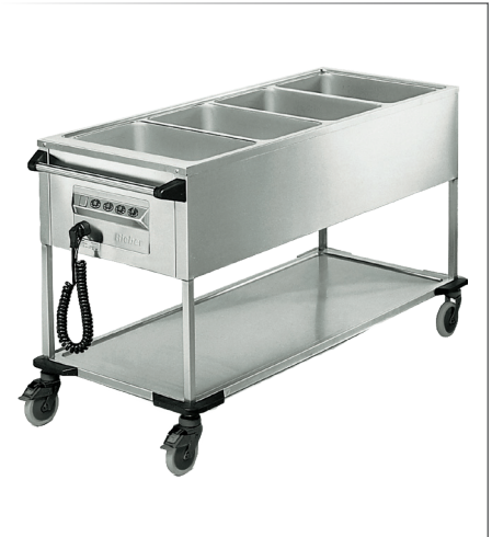
Zubringerwagen ZUB4 RIEBER Edelstahl rostfrei 18/10, naß und trocken beheizbar Fassungsvermögen 4 x GN1/1 200 mm Abdeckung allseitig verkröpft, tiefgezogene Warmhaltebecken eingeschweißt isoliert, spritzwassergeschützt Sicherheitsschiebegriff, Griffstellung stirnseitig Eingeschweißtes Edelstahl-Bord, 4 Stoßbecken Bei trockener Beheizung deutliche Energiesparnis Mit Entleerhahn Schaltelemente stoßgeschützt Spiralkabel 2.5 m, Blindsteckdose, Ein-/Aus-Wippschalter Thermostatregler stufenlos, +30 °C bis +110 °C Rostfreie Rollenausstattung, ø 125 mm, 2 Lenkrollen Nennspannung 1N AC 230V, 50 Hz, Anschlußwert 1.88 kW 156.2x67.5 cm h 90 cm, Leergewicht 55 kg • Art. 119318
