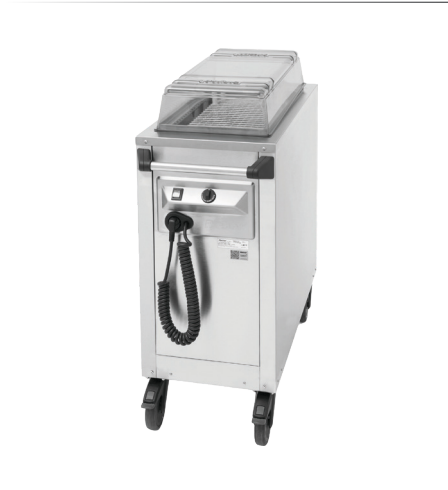
Wechselstapler WE-H beheizt RIEBER Edelstahl rostfrei 18/10 Korpus doppelwandig, isoliert Zuladung max. 150 kg 1 Plattform, kipp- und verkantsicher geführt Federkraft je nach Geschirrgewicht einstellbar Plattform mit 12 Bohrungen 6 Wechselstangen serienmäßig Sicherheitsschiebegriff 4 Stoßecken. rostfreie Rollen ø 125 mm, 2 Lenk-, 2 Lenkstopprollen mit Überhitzungsschutz, stoßgeschützte Schaltelemente Spiralkabel 2.5 m, Ein-/Aus-Schalter, Blindsteckdose Thermostatregler +30 °C bis +110 °C Nennspannung 1N AC 230V 50 Hz. 95.5x48 cm h 103 cm • Art. 119330
