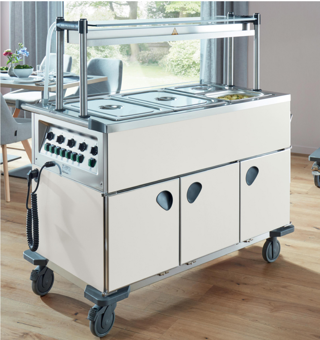
Speisenausgabewagen SAG3 B.PRO Edelstahl rostfrei 18/10 3 Schankräume naß und trocken beheizbar, 30°C bis 80°C mit je 6 Paar Auflagesicken für GN1/1 mit Abstand 57.5 mm Becken separat regel- und beheizbar für 3 x GN1/1 200 mm, Temperaturregler von 30°C bis 95°C Griffstellung stirnseitig, 4 Stoßbecken geprägte Füllstandsmarkierung in den Becken Ablasshahn gegen unbeabsichtigtes Öffnen gesichert Spritz- und strahlwassergeschützt, Arbeitshöhe 900 mm Kunststoffrollen, rostfrei ø 125 mm, 2 Lenkrollen, 2 Lenkstopprollen Bedienfeld mit Ein-/Aus-Schalter, Kontroll-Leuchte, Spiralkabel-Anschluss mit Blindsteckerbuchse Nennspannung 220-240 V, 50 Hz, Anschlußwert 2.85 kW 127.6x71.4 cm h 93.3 cm, Leergewicht 85.5 kg • Art. 119358
