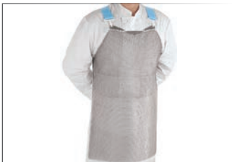
Sicherheitsschurz Aluminiumplättchen (20x19x0.8 mm), verbunden durch Edelstahlringe ø 1 mm nach Norm EN ISO 13998 Stufe 2 mit verstell- und abnehmbaren Trägern • Art. 111372 75x55 cm
