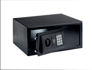
Zimmersafe 11 kg 27 lt Türstärke: 4 mm, Körperstärke: 2 mm elektromagnetische Verriegelung Schlüsselschloss für die Notöffnung Betrieb mit 4x1.5 V Alkalibatterien duroplastige Pulverbeschichtung in schwarzer Farbe Tiefe: 15 mm zusätzlich für Tastatur 43x35 cm h 20 cm • Art. 128101
